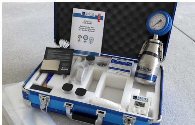
Abb. 20: Beispiel für ein CM Messgerät
